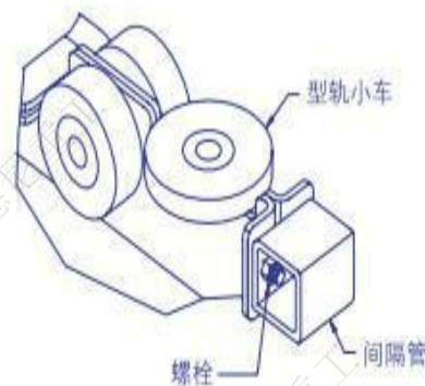
图5C. 在型轨小车上安装间隔管
