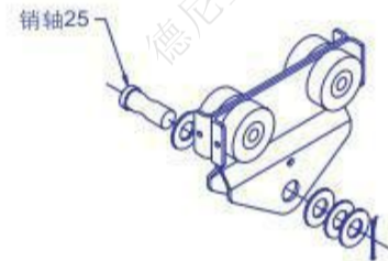
图6C. 在500-1000kg 葫芦小车上安装葫芦
